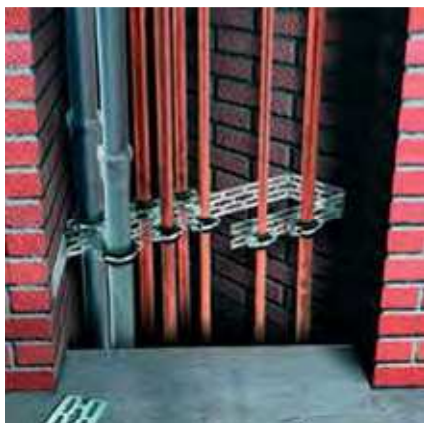
Montage en colonne : Pour la fixation de tuyauteries parallèles, montage avec tiges filetées coupées M8 ou M10
