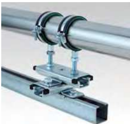
Combinaison de deux curseurs à glissière sur un rail d'installation MPC, sens longitudinal, pour le guidage bilatéral de la dilatation
