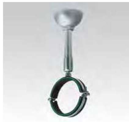
Solution de montage pour espacement important par rapport à la structure avec un tube fileté et un manchon d'adaptation pour collier à vis avec écrou soudé
