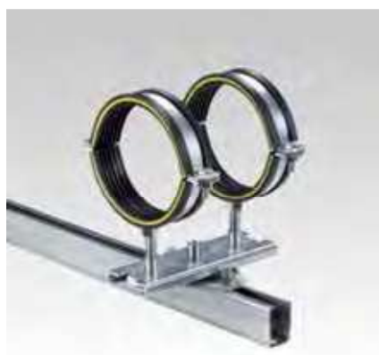
Montage de deux colliers à vis avec embase M16 sur un rail MPC
